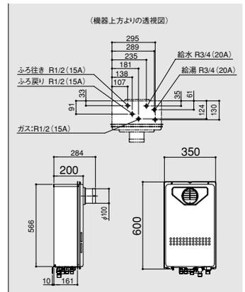
**20号給湯タイプ PS扉内設置形 PRO-TECメカ** <水量サーボ>
