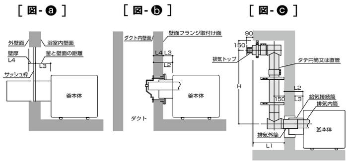
壁厚および釜と壁面の距離について 図-a①②③参照
