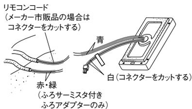
**2** リモコン本体から出ている浴槽サーミスタ接続線(白・白)のコネクタを切断し、風呂アダプターコード(赤・緑)(風呂アダプターに付属)と閉端接続子で接続します。(図1・2)
