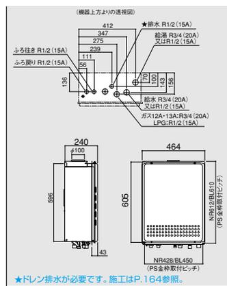
16号給湯タイプ PS扉内上方排気延長設置形 PRO-TECメカ <水量サーボ>
