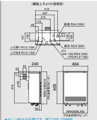
20号給湯タイプ PS扉内後方排気延長設置形 PRO-TECメカ (水量サーボ)
