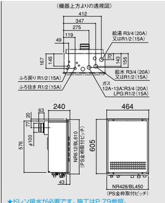
16号給湯タイプ PS扉内後方排気延長設置形 PRO-TECメカ (水量サーボ)
