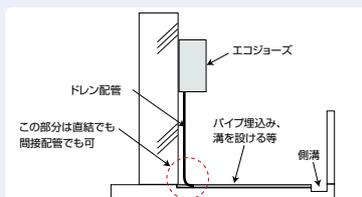
図2 機器がバルコニー設置で側溝に排出する場合
