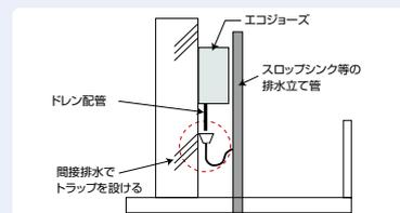
図3 機器がバルコニー設置でスロップシンク等の排水立て管に排出する場合
