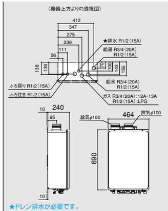
16号給湯タイプ 屋内壁掛/強制給排気形 PRO-TECメカ <水量サーボ>
