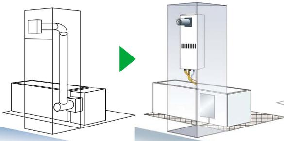
幅25cmのスリムさでチャンバー室設置のBF-C式ふろがまからの取り替えも可能です。
