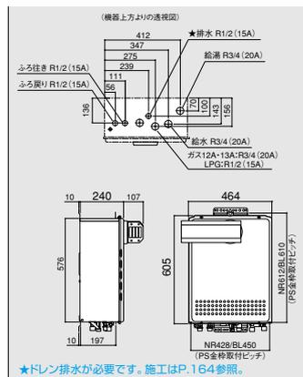
20号給湯タイプ PSアルコーブ設置形 PRO-TECメカ (水量サーボ)
