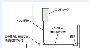
図1 機器がPS設置で片廊下の側溝に排出する場合
