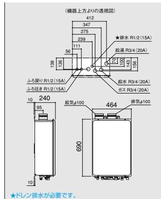
20号給湯タイプ 屋内壁掛/強制給排気形 PRO-TECメカ <水量サーボ>
