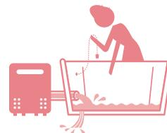
浴槽の排水栓を抜くと追いだき配管内を新しいお湯で洗い流し、湯アカの付着を抑制します。
