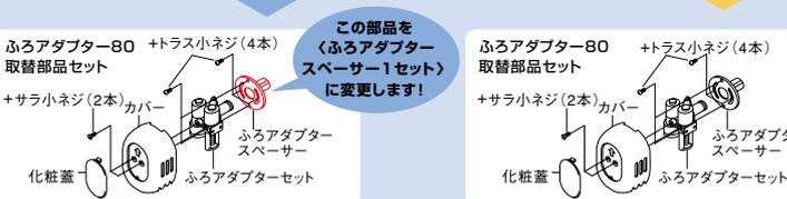
ふろアダプター80取替部品セット      ふろアダプター80取替部品セット
