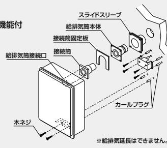
BF式給湯器との取り替えは、FF後方排気タイプの給湯器とBF取替アダプター120Bを併用してください。
