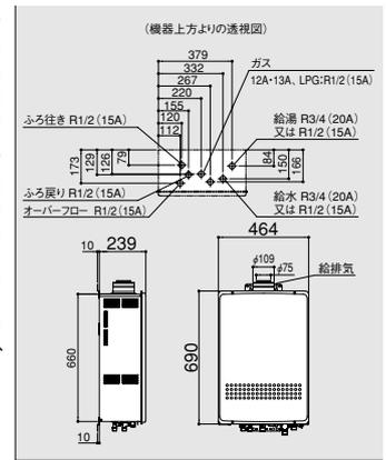
**16号給湯タイプ** 屋内壁掛 / 後方強制給排気形 **Q-TEC制御** <水量サーボ>
