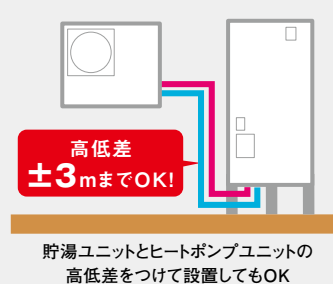
貯湯ユニットとヒートポンプユニットを 離して設置してもOK
